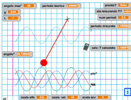
da cui si ricava che, con  $g = 9,81 \text{ m/s}^2$  e  $L = 1 \text{ m}$ , il periodo  $T_0$  per oscillazioni di piccolissima ampiezza è:
